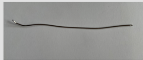
Alambre de aluminio plateado de 1mm de espesor
